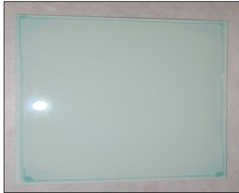
Рис.4. Слой декстрана (10%) с добавкой эмульгатора ОП-10 при 1000 об/мин.
