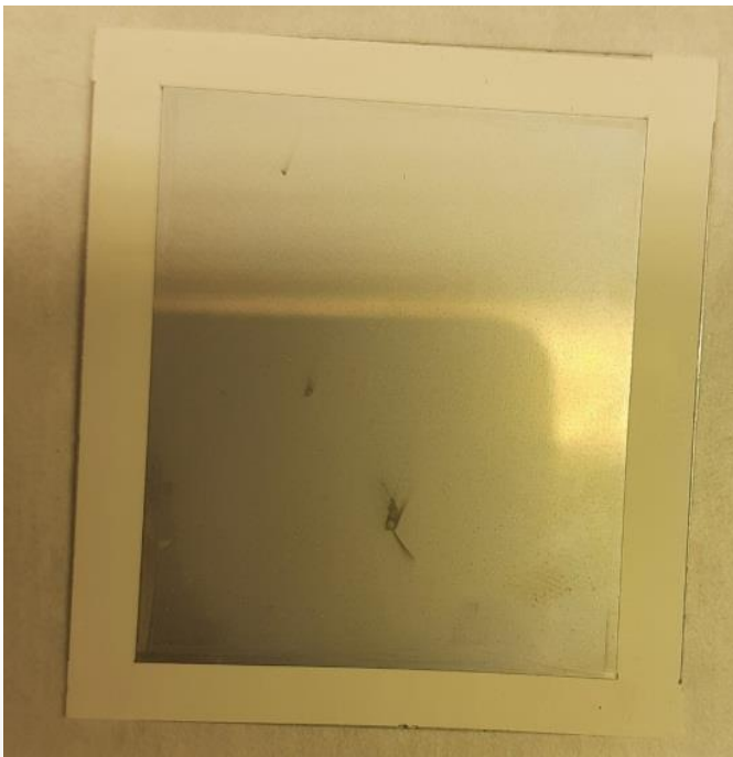
Рис.5. СВС фольга с подслоем солей \text{Na}_2\text{SO}_4 и \text{K}_2\text{SO}_4 .
