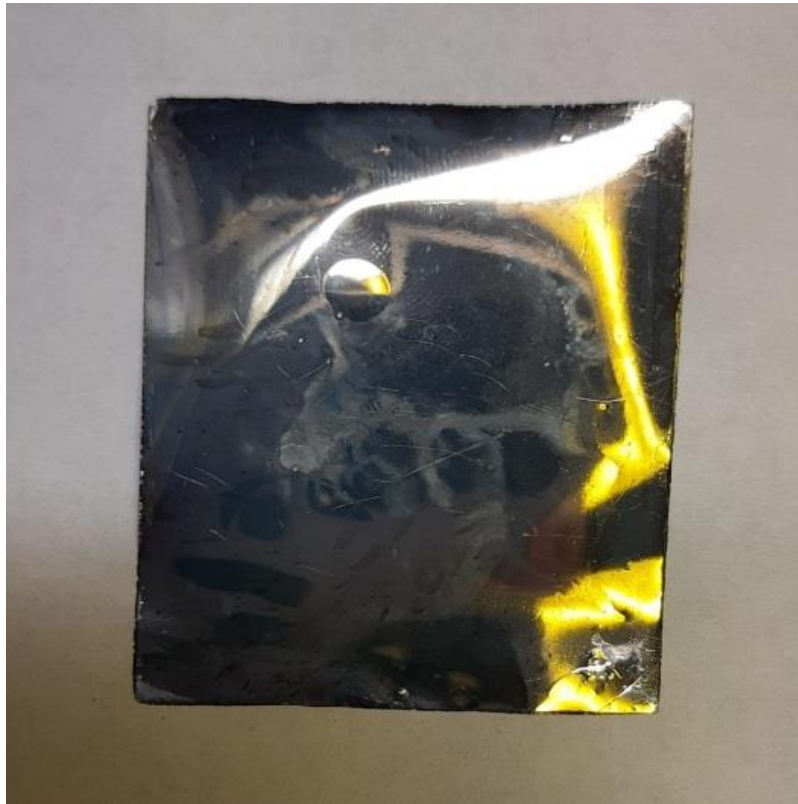
Рис.11. СВС фольга с подслоем декстрана (10%) + ОП-10 после снятия с подложки.
