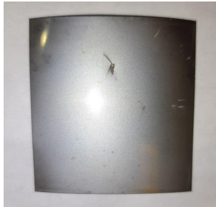
Рис.6. СВС фольга с подслоем \text{Na}_2\text{SO}_4 и \text{K}_2\text{SO}_4 после снятия с подложки.
