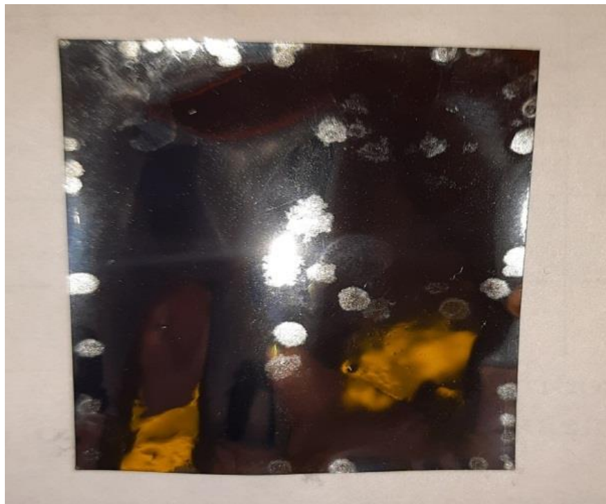
Рис.7. СВС фольга с подслоем поливинилового спирта после снятия с подложки.
